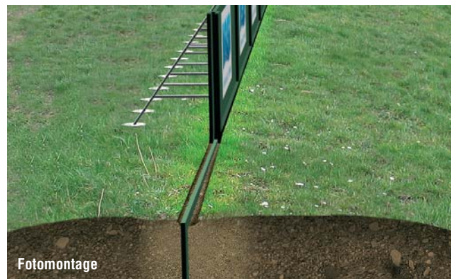
Bei den Deicherhöhungsplatten genügen drei Arbeitskräfte, um in einer Stunde eine ca. 100 m lange Schutzwand zu errichten. Um das gleiche Ergebnis (bei einer Höhe von 1,40 m) mit Sandsäcken zu erzielen, bräuchten Sie ca. 418 Hilfskräfte!
