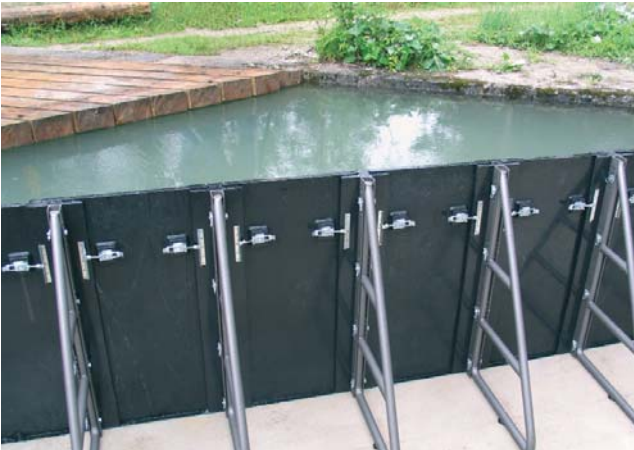
Originalaufnahme eines wissenschaftlichen Versuchsaufbaus: Die Schutzplatten erweisen sich als vollkommen standfest und dicht.
