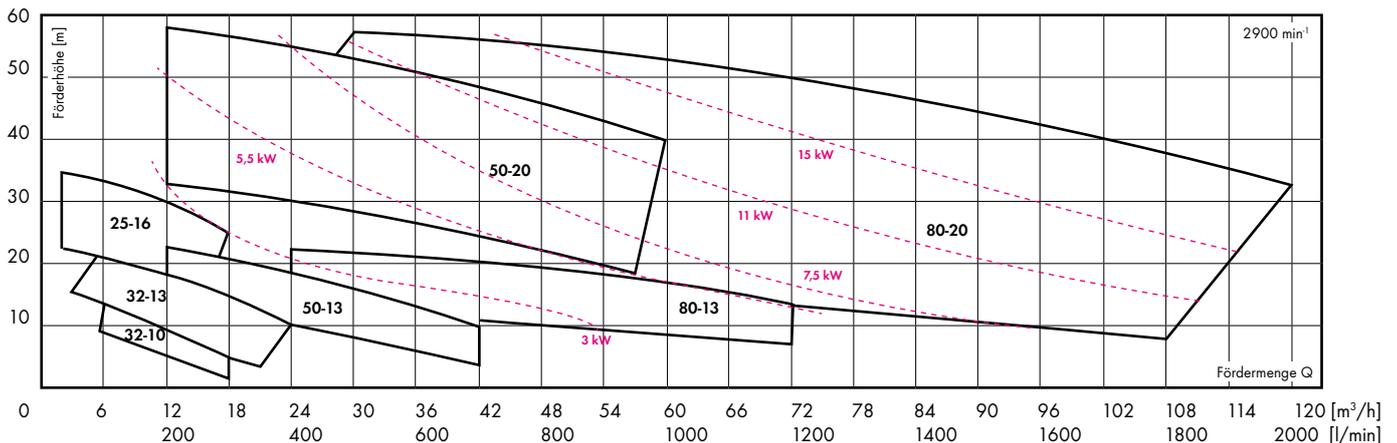
Selbstansaugende Kreiselpumpen der Baureihe SM sind einstufige horizontal aufgestellte Pumpen. Aufgrund ihrer robusten und langlebigen Konstruktion können SM-Pumpen für eine Vielzahl von Anwendungen eingesetzt werden. Durch die zahlreichen
