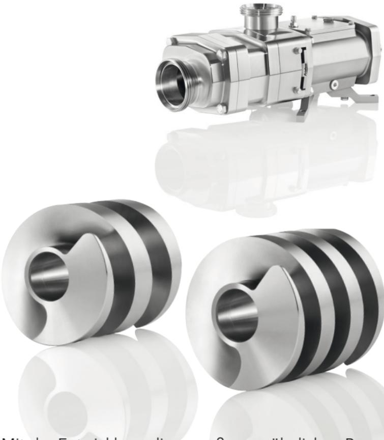
Mit der Entwicklung dieser außergewöhnlichen Pumpe wollten wir in der Doppelschraubentechnologie neue Maßstäbe setzen. Die FDS ist ideal für hochviskose Medien, jedoch gleichzeitig in der Lage, hohe Drehzahlen bis  $3.600 \text{ min}^{-1}$  zu realisieren. Sie bewältigt hohe Differenzdrücke sowie Temperaturen spielend und kann auch niedrigviskose Medien wie Wasser oder Reinigungslösungen in großen Mengen fördern. Dies macht den Einsatz einer zusätzlichen Pumpe für CIP überflüssig.
