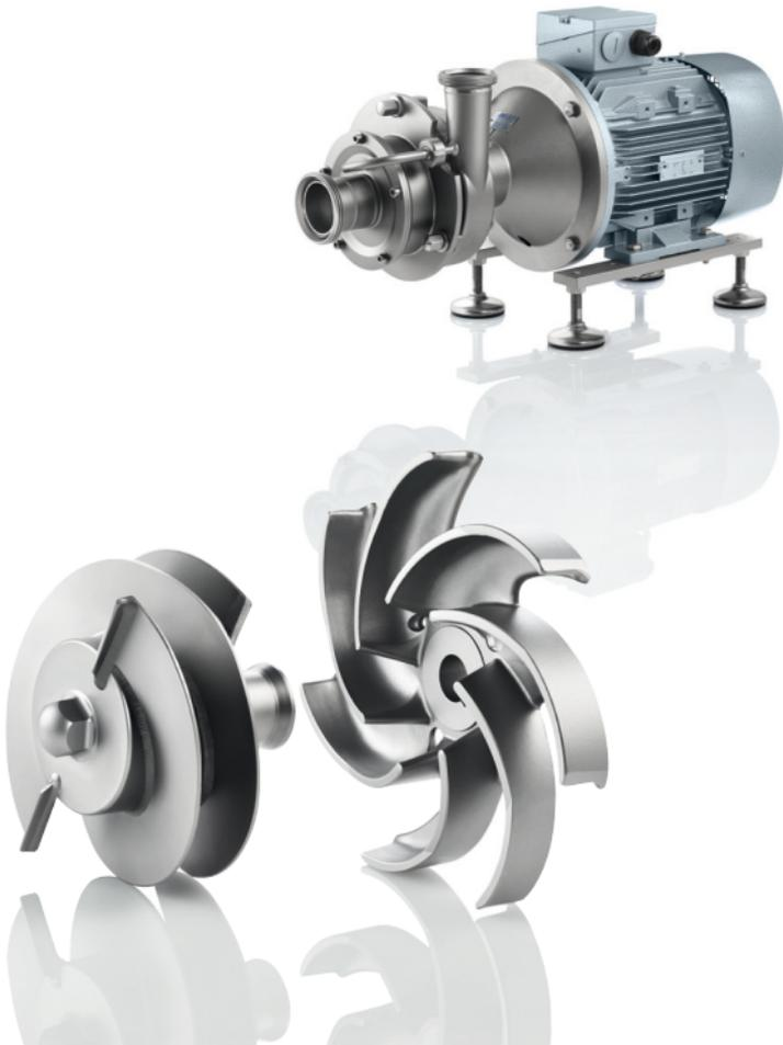
Diese neu konstruierte Pumpe ist speziell geeignet für die Förderung gashaltiger Medien und für CIP-Return Anwendungen. Sie kombiniert das bewährte Fristam Laufrad mit einem Schraubenrotor. Das Resultat ist ein geräuscharmer Hybrid, der Medien mit erheblichem Gasanteil bei hohem Wirkungsgrad fördert. Die FPC ist auch bei der Entleerung von Tankwagen einsetzbar.
