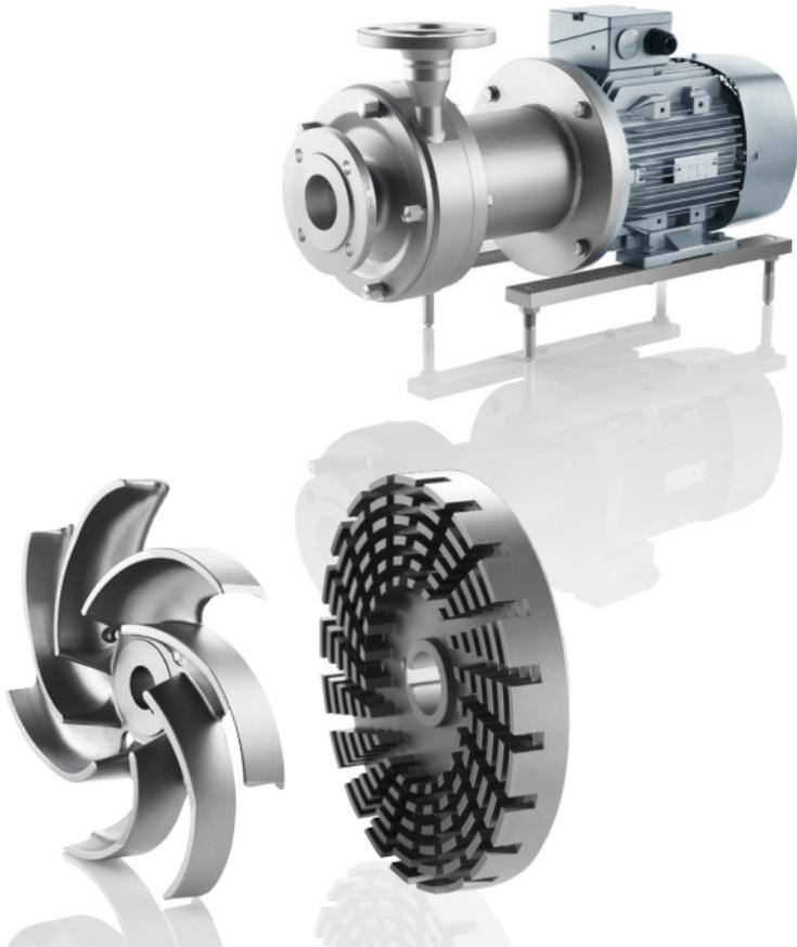
Diese magnetgekuppelten Pumpen wurden für den Einsatz unter besonderen Sicherheitsanforderungen konstruiert. Die FPM / FSM sind speziell für die Förderung von toxischen, gefährlichen oder WGK-Medien geeignet. Das offene Laufrad ist berührungslos über eine Magnetkupplung mit der Antriebseinheit verbunden. Der Produktraum ist durch einen Spalttopf hermetisch von der Umgebung abgedichtet.
