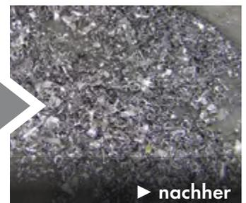
Drehen - Fräsen - Bohren - ist der Werkstoff Aluminium Ihr Metier? Dann können Sie auf teure und aufwändige Spänebrecher in Verbindung mit Hebeanlagen verzichten! Die SZ<sub>CUT</sub> kombiniert bewährtes Kreiselpumpen-Design mit einem Schneidwerk und optimiert so den verschleißanfälligen Transport von Aluspänen in der Kühlschmierstoffrückförderung. An der Ansaugöffnung der Pum-
